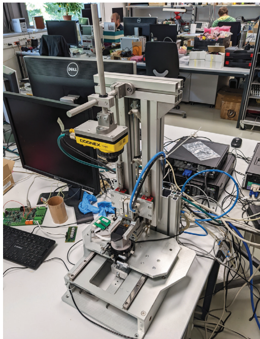
Obr. 1 Pneumatický robot pro lepení LCD modulů
