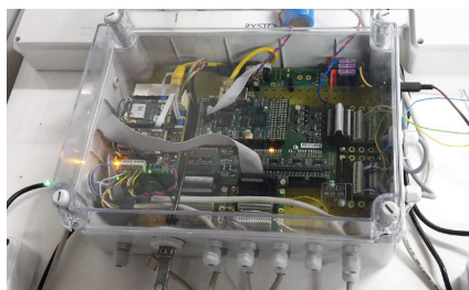
Obr. 1 Pohled na automotive systém s indikátory binárních vstupů a modulem Combi
