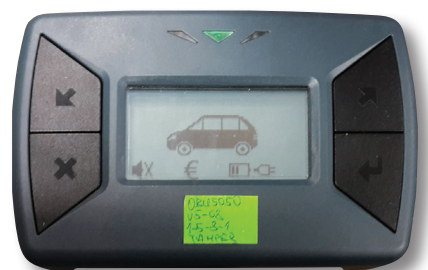
Obr. 7 Vozidlová jednotka (OBU) při funkčním testu
