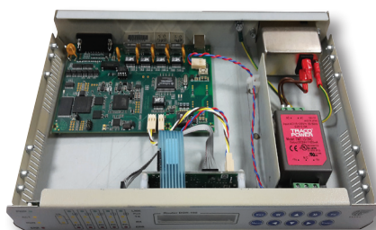
Obr. 4 Deska AŽD:DOR2 s recyklovaným motivem Combi, switchem a rozhraními LAN, X.21 a jednotkou HMI
